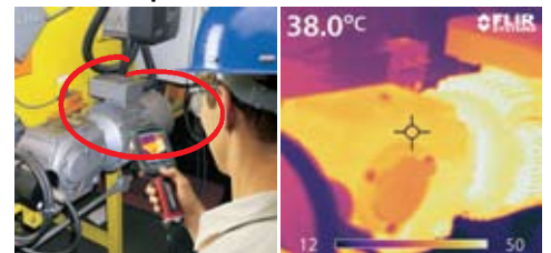
Vérification mécanique d'un moteur électrique au moyen de la FLIR i50.
