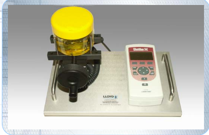
Coulemètre packaging DFSTC coulemètre + étau à plots de moyenne et grande capacité
