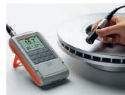
DELTASCOPE® FMP30 avec sonde bipolaire V7FKB4 – disque de frein de camion
