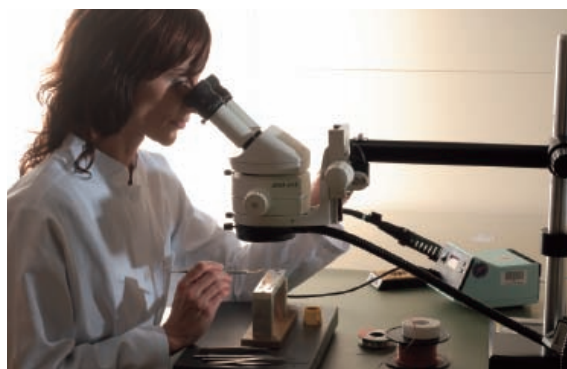
Fabrication des sondes au microscope
