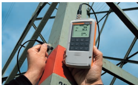
DUALSCOPE® FMP40 et sonde Duplex FDX10 pour des applications extérieures
