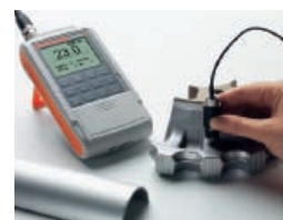
ISOSCOPE® FMP30 et sonde FTA3.3 – jante en alliage léger
