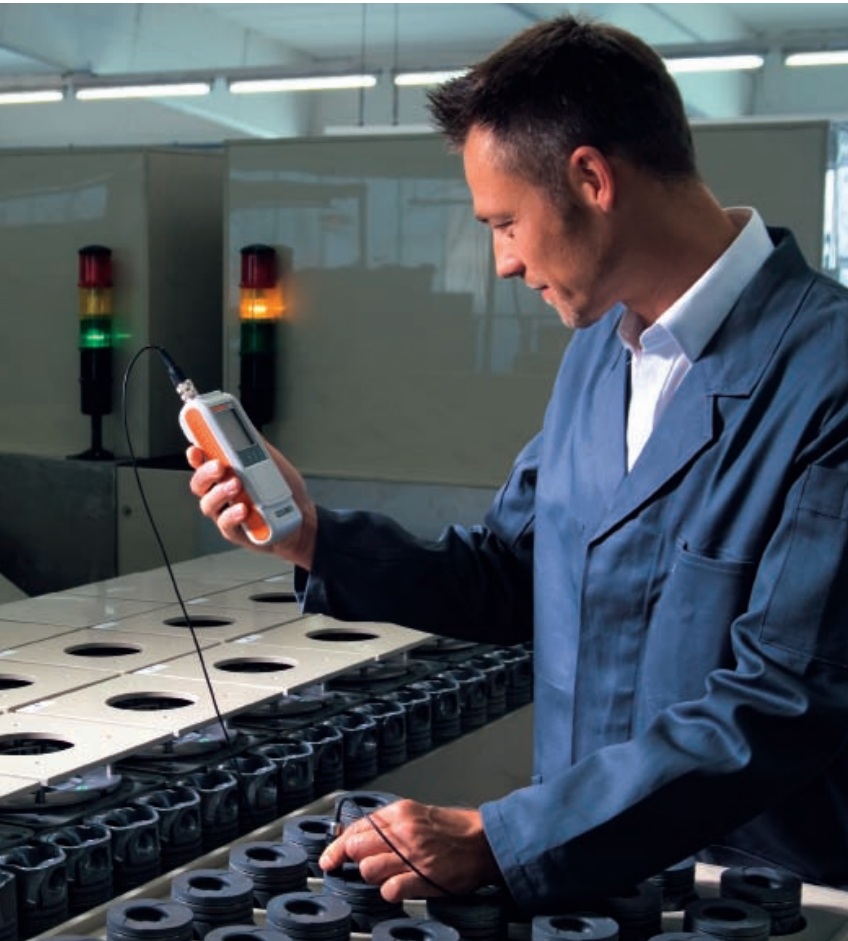
Contrôle qualité de piston moteur immédiatement après fabrication avec une sonde FTA3.3H
