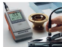
DUALSCOPE® FMP40 et sonde FD13 – mesures sur petites pièces de divers matériaux
