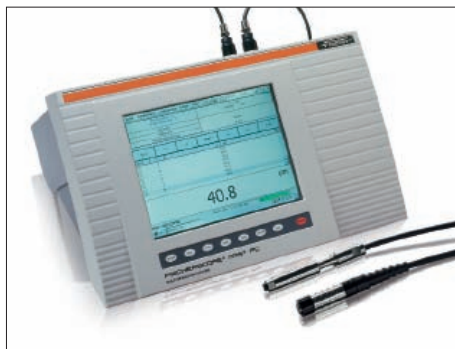
FISCHERSCOPE® MMS® PC2, système de mesure unique pour la mesure d'épaisseur de revêtement et l'analyse générale des matériaux intégrant différentes méthodes telles que le magnétisme, l'induction magnétique, les courants de Foucault et la rétrodiffusion Béta
