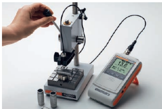
DUALSCOPE® FMP40 – grâce à l'utilisation d'une table de mesure, les pièces cylindriques sont parfaitement positionnées et mesurées avec précision
