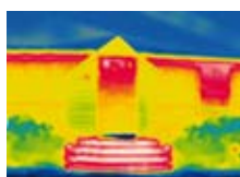
Bâtiment : déperdition énergétique
