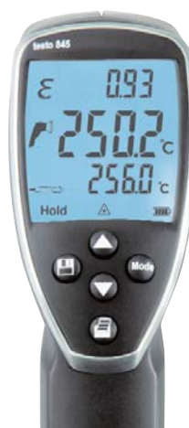
Aperçu de l'affichage avec sonde de contact °C raccordée : facteur d'émissivité, valeur en cours mesure infrarouge °C et °C sonde de contact
